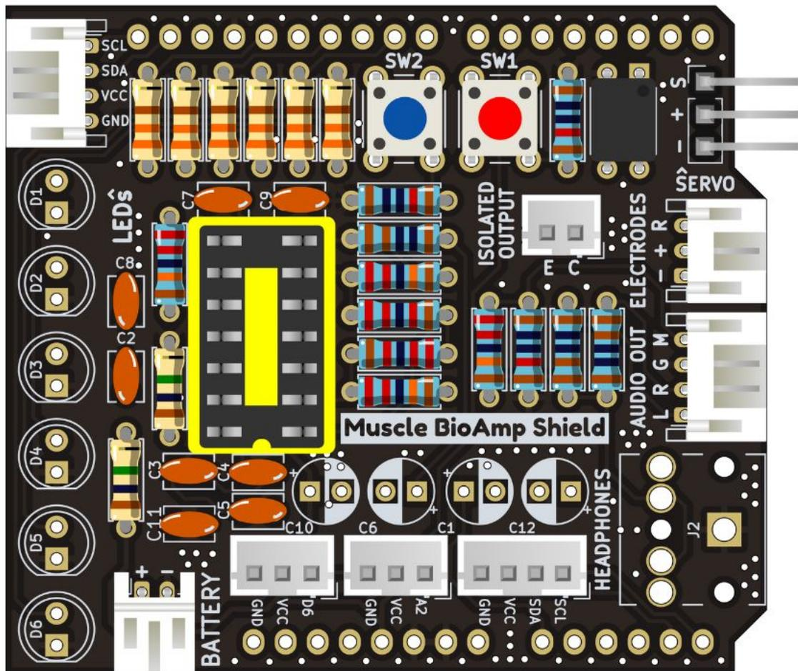
Fig. 23: Step 16 - IC Socket
